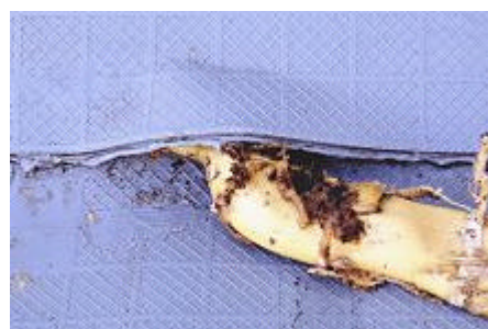
Abb. 6: Rhizom-Eindringung in eine Naht bei der TPO-Bahn 1,6 mm ( Phyllostachys humilis , Januar 2006)
