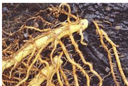
Abb. 5: Rhizom-Durchdringungen bei der PYE-Bahn ( Phyllostachys bisseti , Januar 2006)
