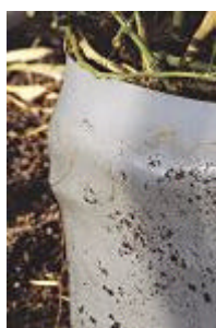
Abb. 4: Deformatio- nen der TPO-Bahn 1,8 mm (Jan 06)
